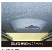
押抜き荷重: 0.32kN(変位13mm)
